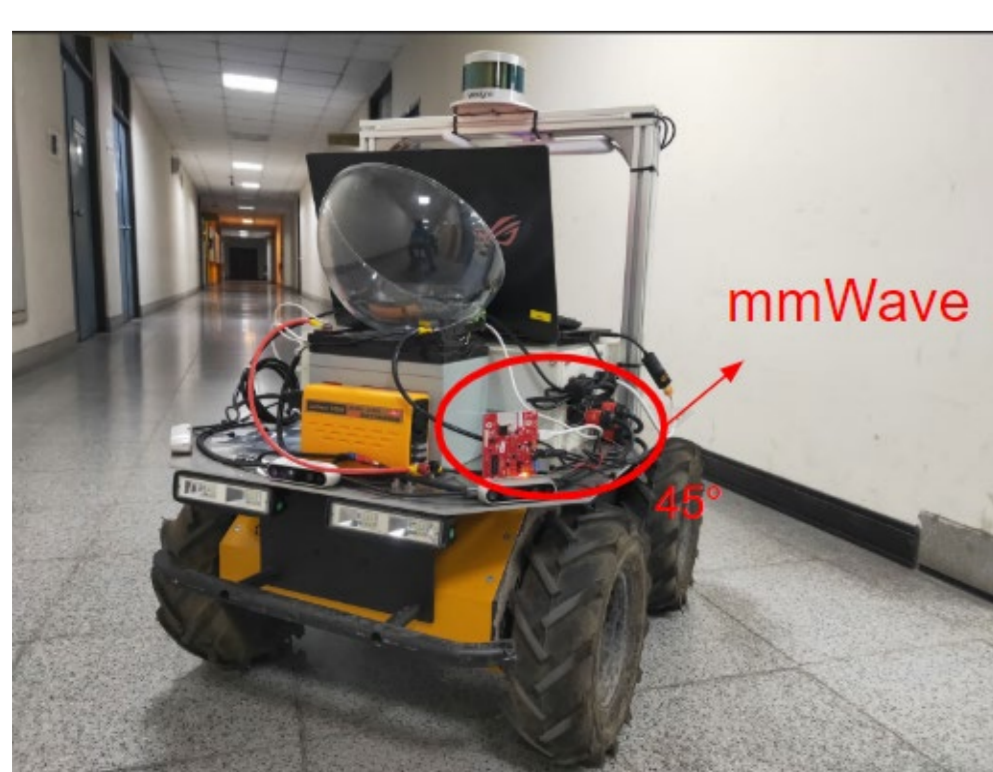
(a) 於載具45°角位置裝設毫米波雷達
